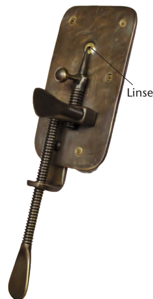
Figur 105. Kopi af Leeuwenhoeks hjemmelavede mikroskop. Mikroskopet er ganske lille og håndholdt. Objektet anbringes foran linsen, og man ser gennem linsen fra den anden side.
